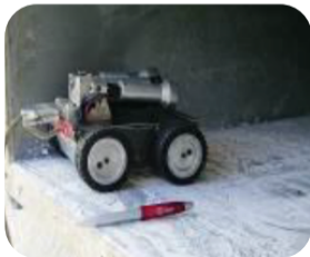
Robô no duto mockup em teste - vista lateral
